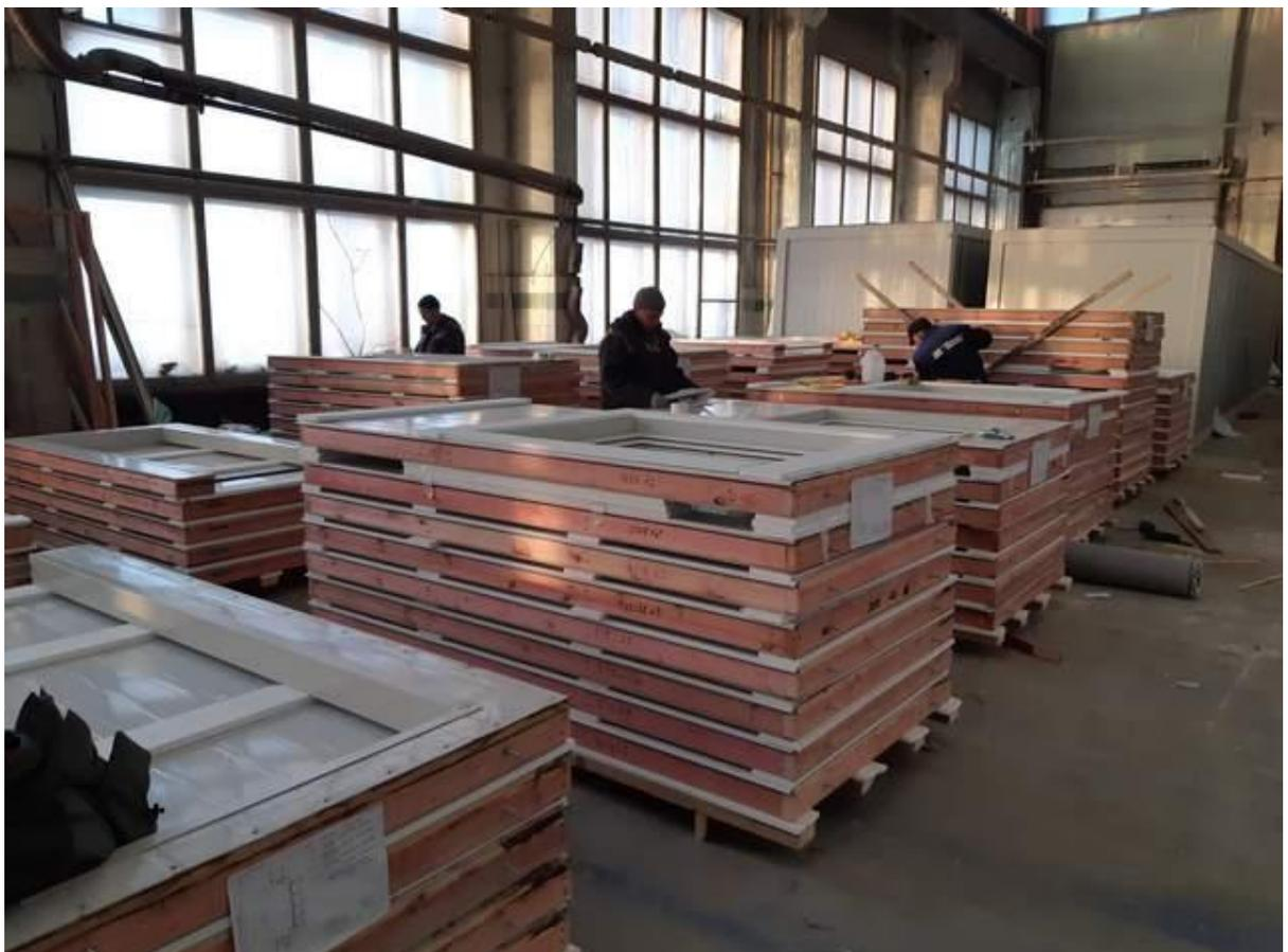
Рис.3 Производство панелей для сборно-разборных контейнеров
